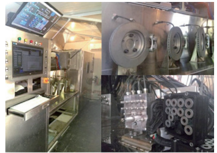
▲ 汽车 ESC 全工况液压试验台
